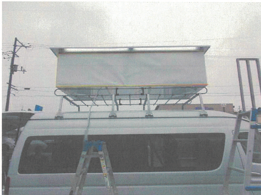
市販のルーフキャリアの外枠上に看板を取付けたもの。
