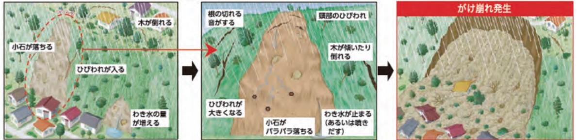
地中にしみ込んだ水分が地盤を弱め、雨や地震などの影響によって急激に斜面が崩れ落ちることをいいます。
